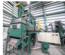
ナゲットとは、被覆線を破碎・粉砕して被覆を除去し、米粒大に加工したもの。当社ナゲットシステムは高純度の銅を効率良く抽出可能。
